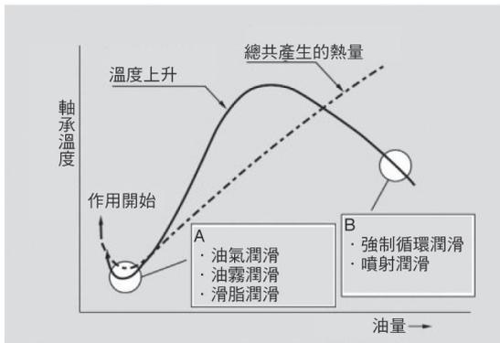
圖6-1 油量、摩擦損失和軸承溫度之間的關係
