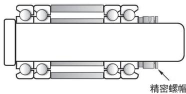
圖 8.2 精密螺帽固定鎖緊軸承
