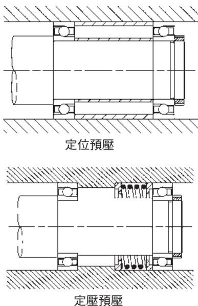
圖5-1 軸承定位預壓和定壓預壓方式
