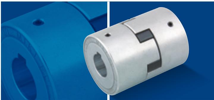
2个毂之间夹入缓冲材料（星形弹性体），是结构简单的爪形联轴器。毂材质采用铝合金，极为轻量。只需通过轴向移动，就能简单进行输入输出的连接·分离。
