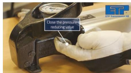
**5b.** Trycksätt tills föreskrivet monteringstryck kan hållas, c:a 5-10 sekunder, för att säkerställa att kolven nått rätt position. Vid trycksättning kommer trycket att öka stevvis. Detta beror på att kolven inuti ETP-HYLOC rör sig framåt etappvis.
