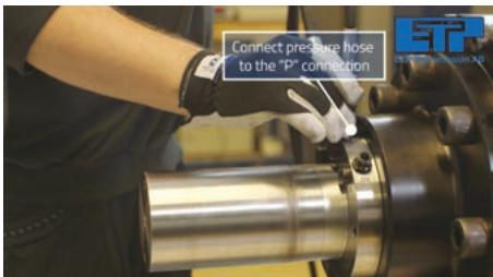
4c. Raccorder la ligne de pression à la pompe à l'orifice ON.
