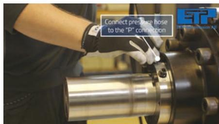
4c. Den Druckschlauch der Pumpe auf den ON-Anschluß anschließen.
