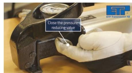
**5b.** Effectuer la mise en pression en maintenant la pression recommandée pendant environ 5 à 10 secondes. Lors de la mise en pression, la pression augmente par palier en raison du déplacement graduel du piston à l'intérieur du ETP-HYLOC.
