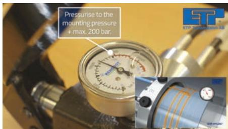
**3c.** Osservare il manometro sulla pompa. Quando la pressione improvvisamente s'abbassa (il pistone interno ETP-HYLOC ha iniziato a muoversi); continuare a pompare fino ad arrivare a zero e sino a che l'ago del manometro inizia a salire. Il pistone a quel punto è completamente arretrato.
