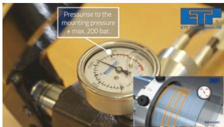
**3c.** Beobachten des Manometers. Wenn der Druck plötzlich fällt (der Kolben in der ETP-HYLOC beginnt sich zu bewegen), kontinuierlich weiterpumpen, bis der Druck auf Null gefallen ist und wieder anzusteigen beginnt. Der Kolben in der ETP-HYLOC hat seine Endposition erreicht.
