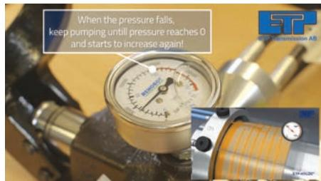
**4.** Ouvrir la vanne de détente au niveau de la pompe. (Chute de pression dans la conduite). Le manchon ETP-HYLOC est desserré.
