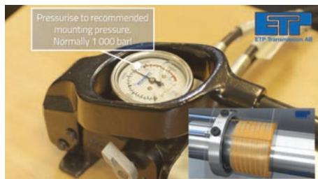
**6.** Ouvrir la vanne de détente au niveau de la pompe. (Chute de pression dans la conduite).
