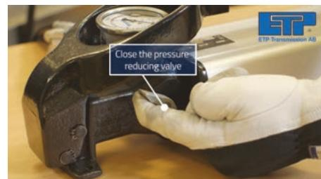
**5b.** Druckbeaufschlagung bis zum Erreichen des Montagedrucks, welcher für ca. 5-10 Sekunden gehalten werden soll. Während der Druckbeaufschlagung baut sich der Druck stufenweise auf, da sich der Kolben in der ETP-HYLOC ruckweise bewegt.
