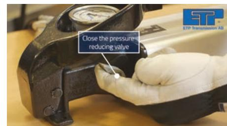
**5b.** Dare pressione sino al valore stabilito e mantenerla per 5/10 secondi. Durante la fase di messa in pressione, quest'ultima salirà per gradi in quanto il pistone si muove gradualmente.
