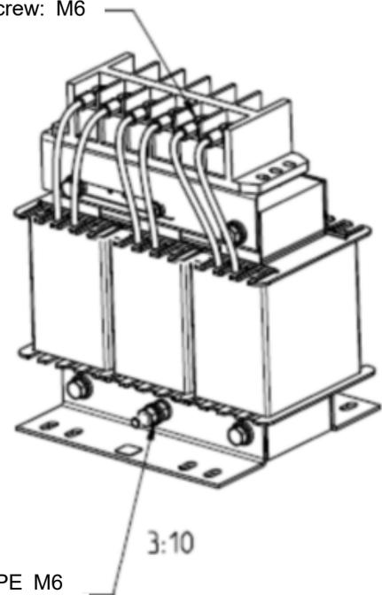
Tightening torque:  $3 \pm 1.5$  Nm
